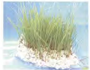
廃ガラス発泡化材上での芝の植生実験
