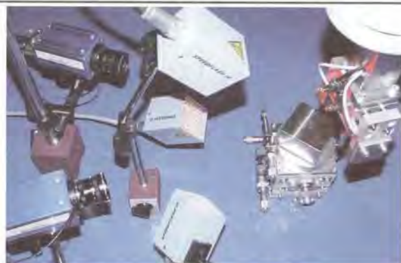
図2 ステレオ高速度カメラと同期型半導体レーザー照明装置の構成
