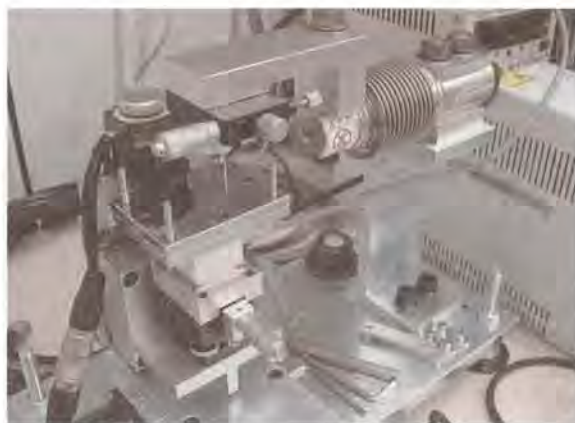
図4：引っ掻き試験機
