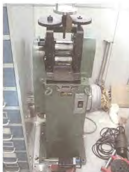
図1：積層用圧延機
