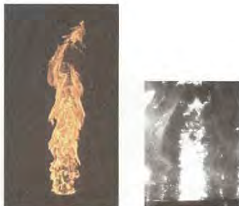
図2 バイオディーゼル燃料の連続噴霧火炎(左:直接写真、右:レーザーシート断面像)
