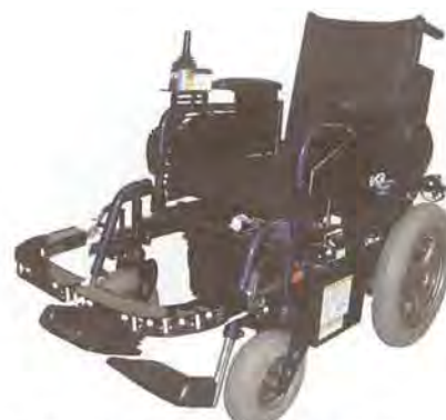
図2 自律的障害物回避機能を備えた知的電動車椅子
