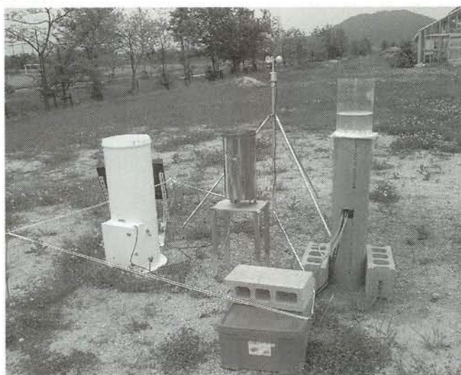
写真 各種降水量計の比較試験(左から NOAH 重量式、転倒マス、試作機)
