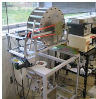
2点曲げ強度試験のためのガラスファイバー作製装置
