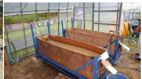
図3 石灰系改良土の表面流出試験
